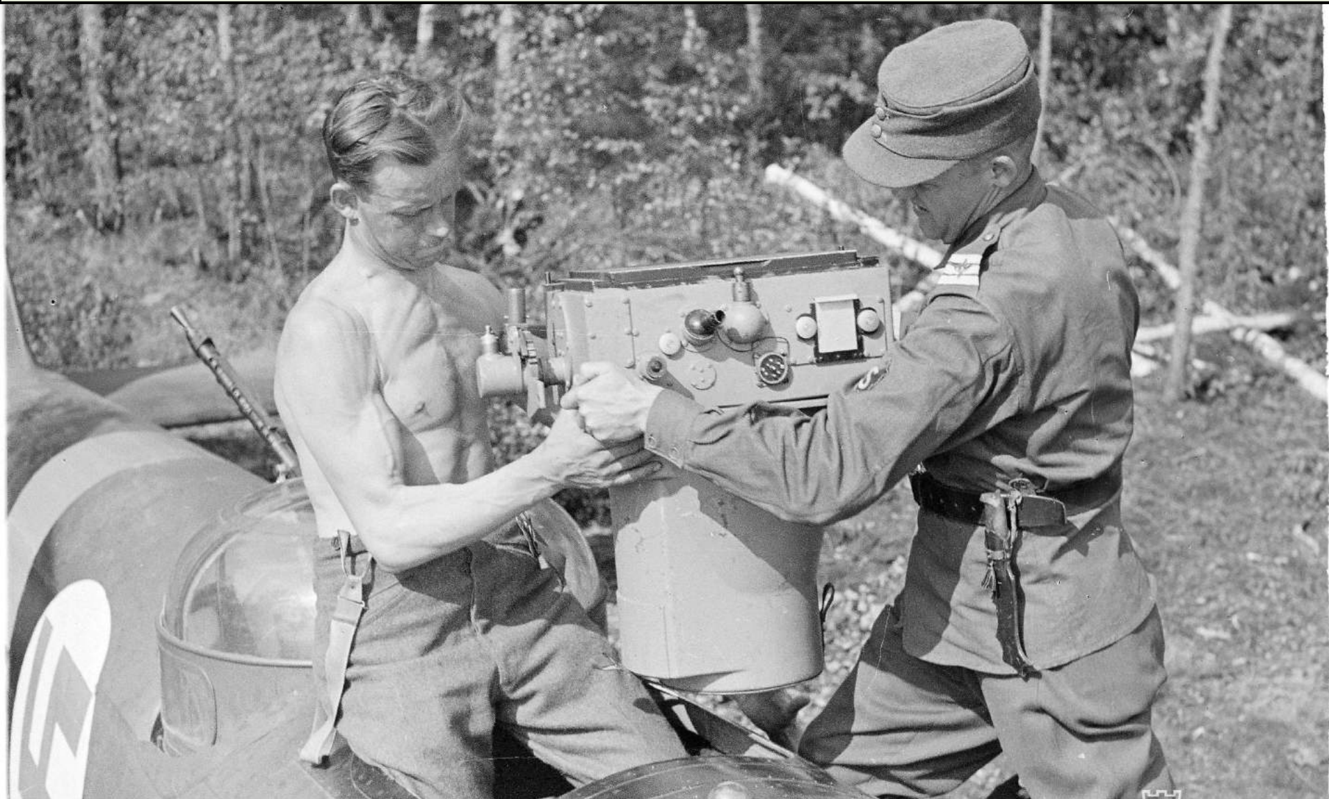
Pitkäpolttovälistä Zeiss Jenan valmistamaa tiedustelukameraa nostetaan pommikoneeseen
